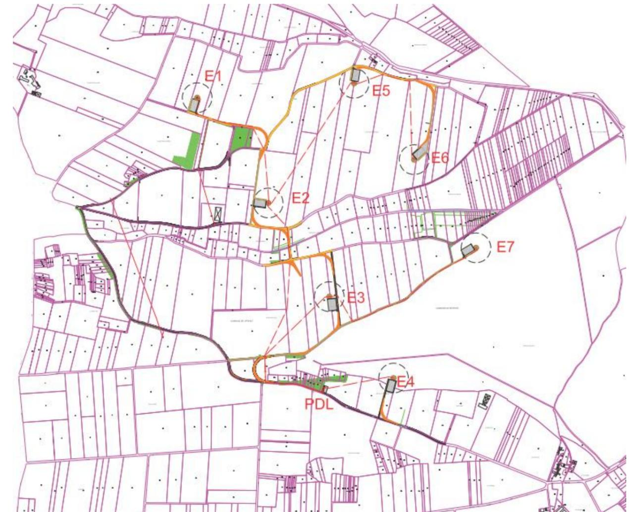
Schéma d'implantation des éoliennes
